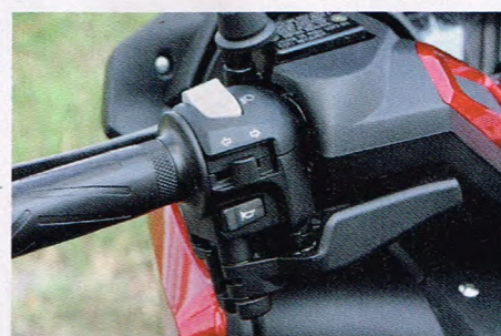
Feststellbremse gegen unbeabsichtigtes Wegrollen.
