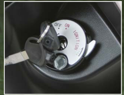
Zündschloss mit Wegfahrsperre und ein zweckmäßiges analoges Cockpit gehören zur Grundausstattung des Retro-Fuffis.
