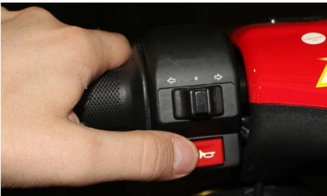
Die Hupe funktioniert nur bei eingeschalteter Zündung oder bei laufendem Motor.
