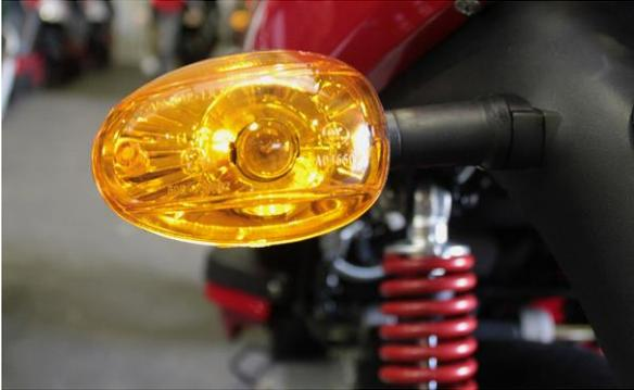
Zündschlüssel auf ON stellen, den Blinkerschalter in beliebige Richtung stellen, die Blinkleuchten sollten in gleicher Blinkfrequenz pro Seite aufleuchten, falls nicht prüfen sie die Glühlampe und Kontakte. Oder wenden Sie sich an Ihren MW Fachhändler.
