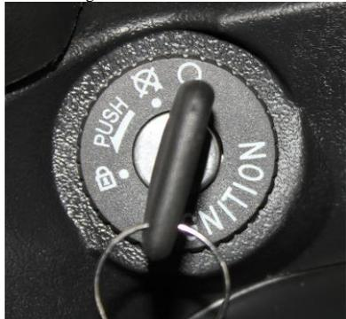
LOCK Zündschloss ist abgeschlossen, indem Sie den Lenker nach links drehen und den Schlüssel auf LOCK drehen Sie können den Schlüssel entfernen. Die Lenkersperre ist aktiviert. Die Stromzufuhr wird unterbrochen.
