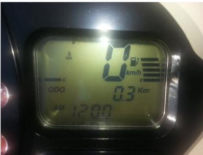
Zeigt den Stand des Kraftstoffes bei eingeschalteter Zündung oder laufendem Motor.
